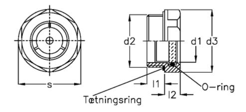
d1 = 18 d2 = M26x1.5 d3 = 32 l1 = 9 l2 = 8 Max pressure = -Max vacuum mbar = s = 30
